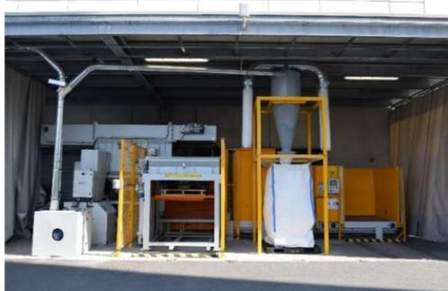
con uno svuotamento tramite lame rotanti e sbattitori per massimizzare il coefficiente di svuotamento per sacco, da qua per caduta gravimetrica abbiamo la separazione del materiale primo dal sacco, il quale viene sganciato da un contro pettine.
